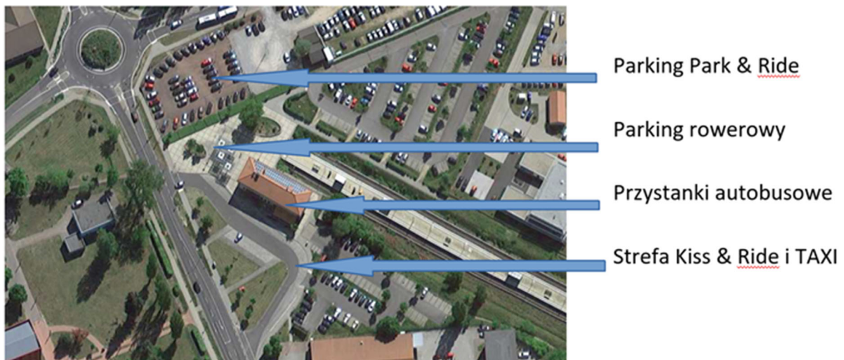
Rysunek 13. Przykład rozplanowania węzła przesiadkowego
